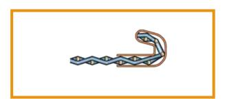
平行折弯用作横向张紧装置,折弯10-20度, 半径4mm,生产范围达到丝径6mm。
