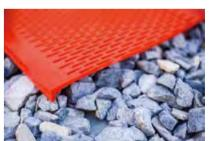
驰涨筛是由高密度的聚氨酯片做成的,每块筛片固定到主框架和次共振框架上,通过对次共振框架中的主框架的筛分振动进行放大、并且聚氨酯板筛被固定在两个框架上,筛板碰撞在一起产生"翻转"运动。这样确保筛分材料不会粘在或者卡在筛网上。
